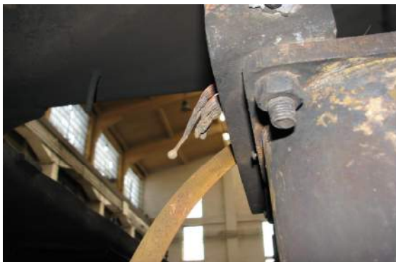
Foto 9 - Cablurile motorului electric de acționare a compresorului - amplasate deasupra bateriei de silicagel - prezintă topitura de cupru
