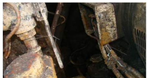
Efectele incendiului în partea stângă a dynastarterului la cutia de borne
