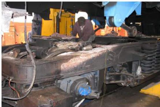
Foto 11 - rama boghiului II prezintă urme de ardere în partea superioară, în zona MET 4
