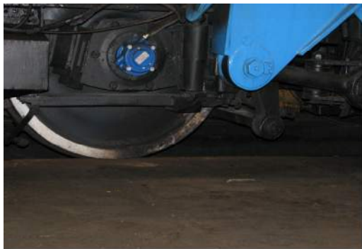
Foto 12 - bandajele de la roțile osiilor 3 și 4 prezintă urme de fum
