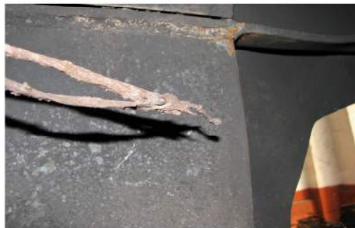
Foto 8 - Cablurile motorului electric de acționare a compresorului - sudate deasupra culoarului de acces
