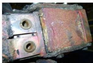
Lamela de contact topită, de la contactele de lucru la S4.1
