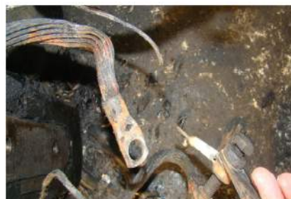
Bornă B1 cu contact imperfect între papuc și placa de legătură cu borna E2
