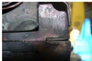
Urmă de supraîncălzire la contactele de rupere la S4.1
