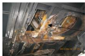
Burdul pentru aerul de ventilație al motorului de tracțiune nr.3 și garnitura de etanșare dintre burduf și motor arse în totalitate
