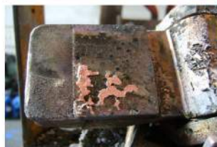
Urme de sudură pe contactele de rupere la S4.1
