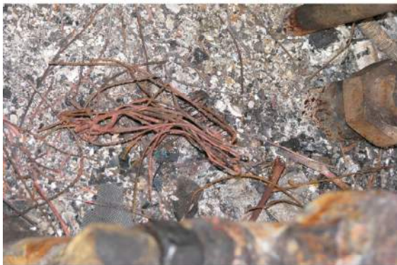
Foto 10 - Mănunchi de cabluri din circuitul de alimentare a motorului electric ventilație compresor și din circuitul de supraveghere a funcționării compresorului, topite și sudate între ele de cuprul topit
